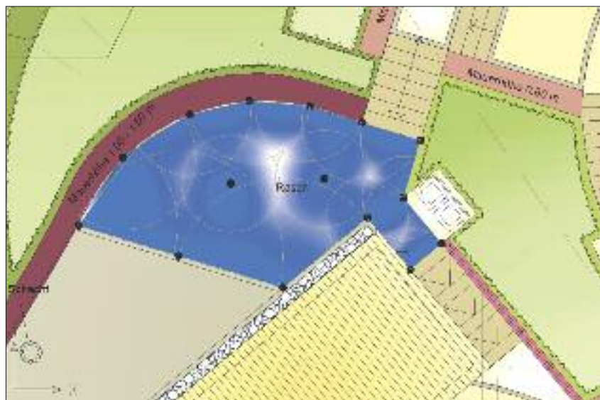
Bewässerungs-Modul bei Dataflor: Regner setzen, Wurfweite, Radius und Hydraulik automatisch berechnen lassen.
